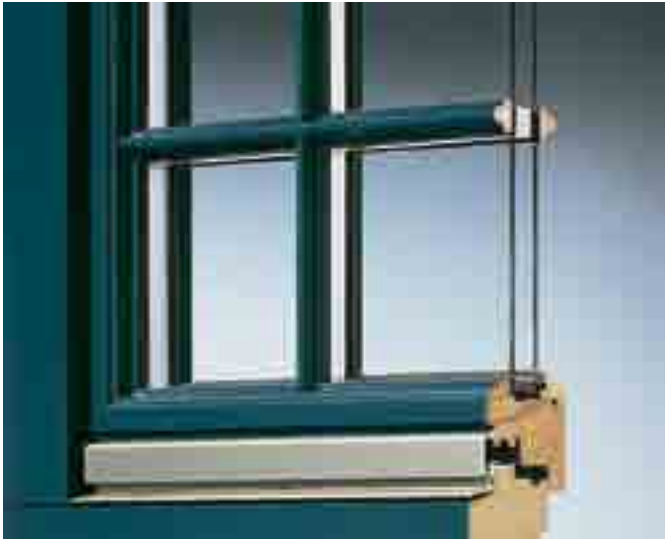
ASA/ZF: aufgesetzte Zierfalzsprosse mit oder ohne Abstandhalter, Trapezfalzglasleiste innen
